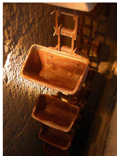
Skopelevatoren transporterade klinkern vidare upp i lagerbyggnaden där den tippades för avvalning. Foto: LKU
