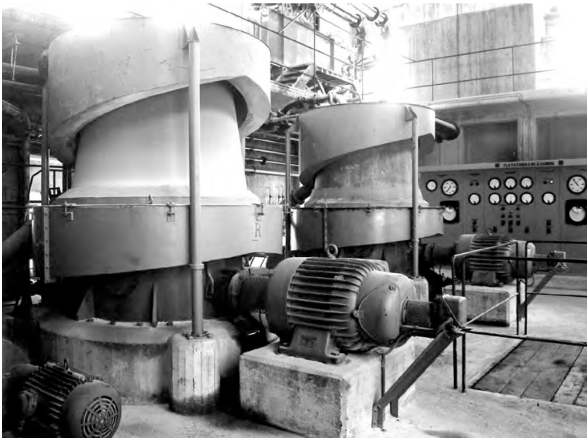
Två av flotationsanläggningens tre centrifuger. Grovslammet passerade genom dessa och delades upp i grovt och fint. Centrifugerna är placerade högst upp i flotationsanläggningshuset. I bakgrunden syns manöverskåp. Allt levererat av FLS.
