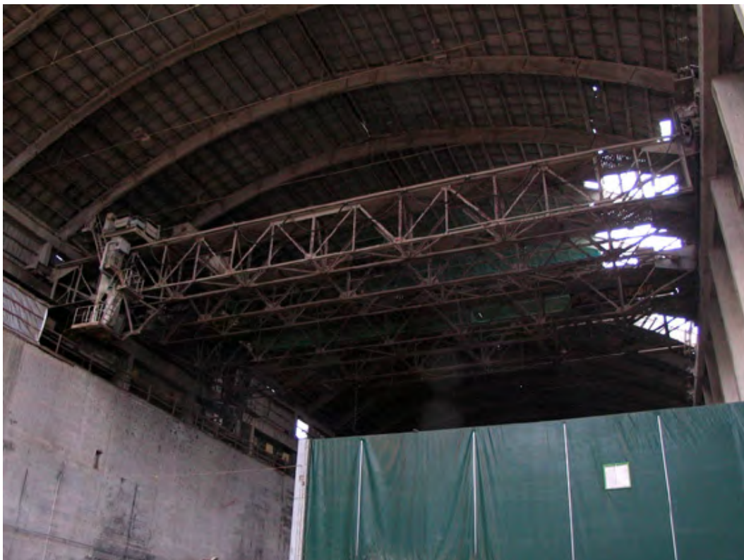
Här syns de två traverser som användes vid hanteringen av de olika material som lagrades i byggnaden. Takhöjden är ca 30 m. Foto: HL
