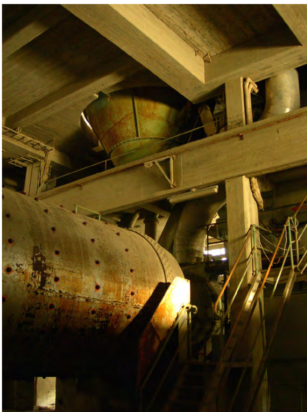
Denna bild visar tillsatskvarnen (den mindre till höger i bild) och Slamkvarn 4 som ursprungligen var Cementkvarn 1. Kvarnarna ansluter till fickbyggnaden där inmatningen skedde. Foto: LKU
