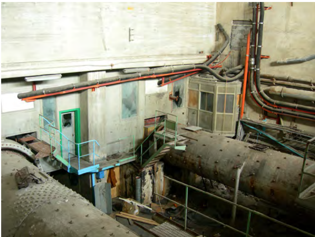
Denna bild visar tillsatskvarnen (den mindre till höger i bild) och Slamkvarn 4 som ursprungligen var Cementkvarn 1. Kvarnarna ansluter till fickbyggnaden där inmatningen skedde. Foto: LKU
