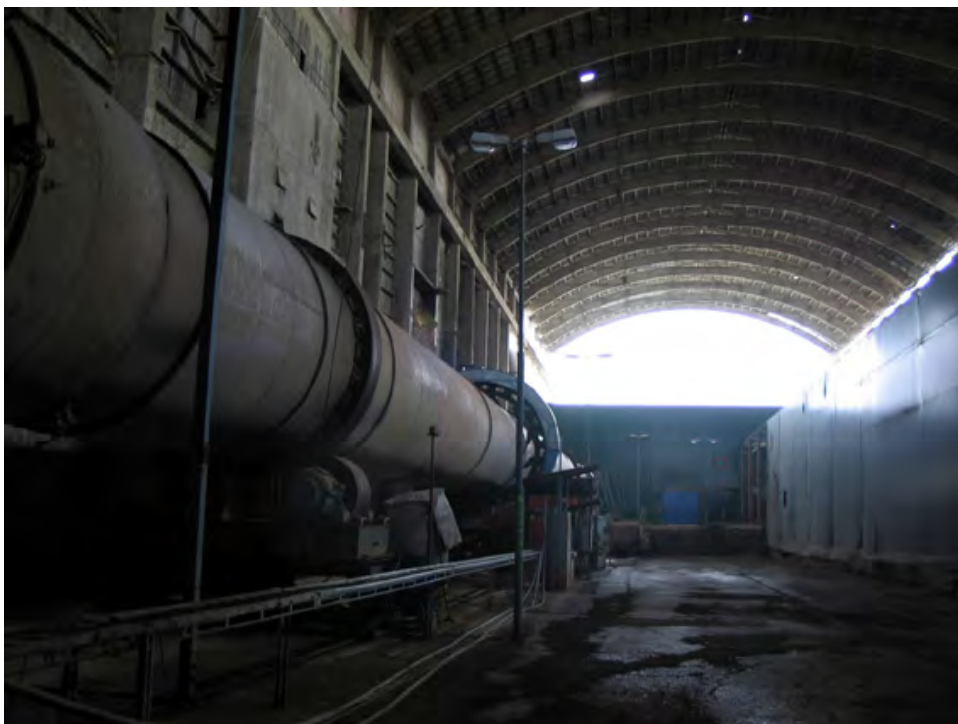
Lagerbyggnaden inifrån. En av roterugnarna som användes för att framställa cement har flyttats hit från ugnshuset. Ugnen är inte komplett; delen där kylarsystemet satt saknas. På bilden syns nästan hela den återstående ugnen. Lägg märke till gatlyktorna som kan berätta något om byggnadens väldiga rymd.
