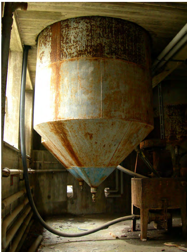
Vi går in genom en dörr i flotationsanläggningens norra fasad. Direkt till vänster innanför dörren finns tre behållare för flotationsprocessens kemikalier. Här ses en av behållarna.
