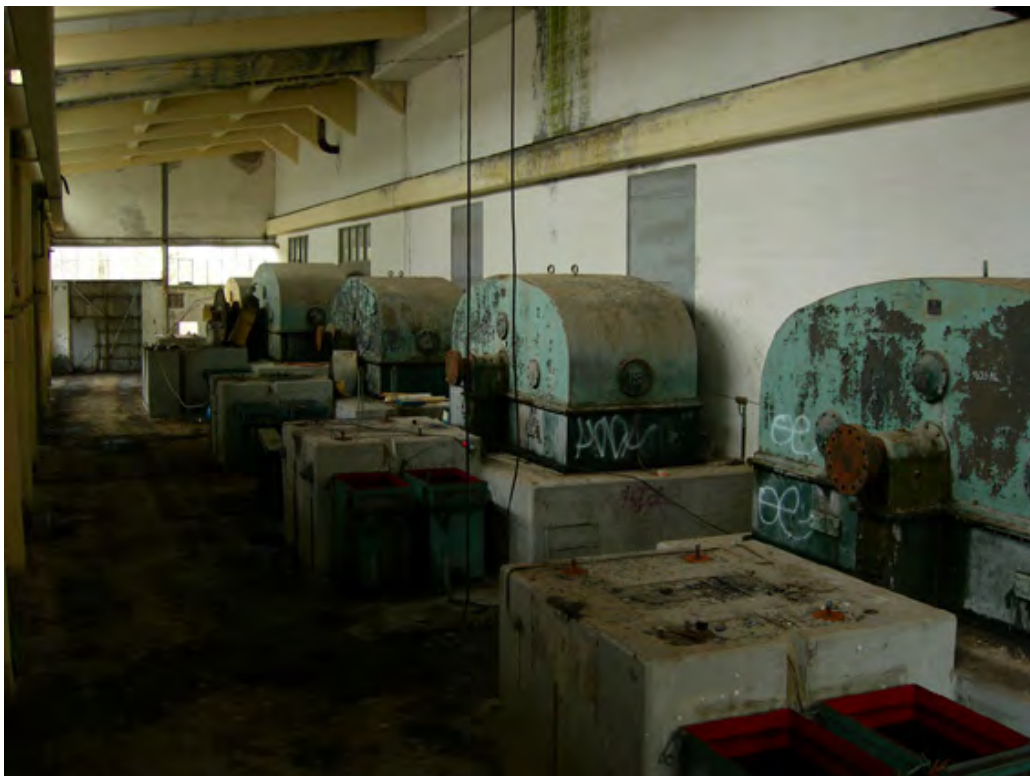
Här syns fem av de sex precisionsväxlar (F L S Symetro) som finns kvar i kvarnhuset. Växlarna är kopplade till varsin kulkvarn. Kvarnarna finns bakom väggen. När anläggningen var i drift stod motorer på betongfundamenten framför växlarna. En skarv i väggen mellan den tredje och fjärde växeln visar var det ursprungliga kvarnhuset slutade. Växlarna hör till Slamkvarn 4, Cementkvarn 2, 3, 4 och 5 framifrån räknat.
