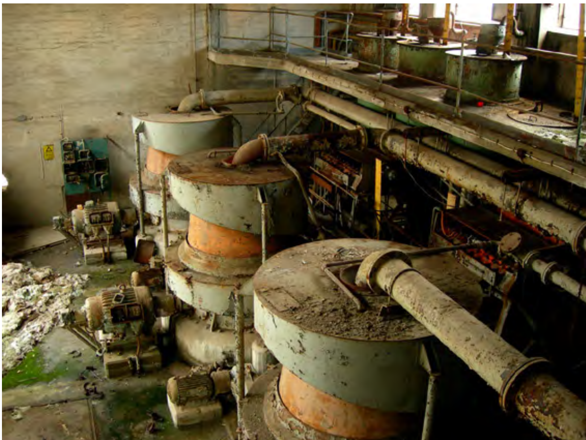
Flotationsanläggningens tre centrifuger där grovslammet passerade för att delas upp i fint och grovt. På en avsats ovanför centrifugerna syns tre behållare för kemikalier.
