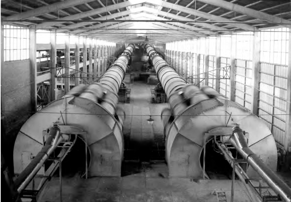
Ugnshusets två roterugnar sedda från ovan. Närmast i bild syns båda ugnarnas planetkylare. Fönsterraderna högst upp på väggarna ger ett vackert ljusinsläpp i lokalen.
