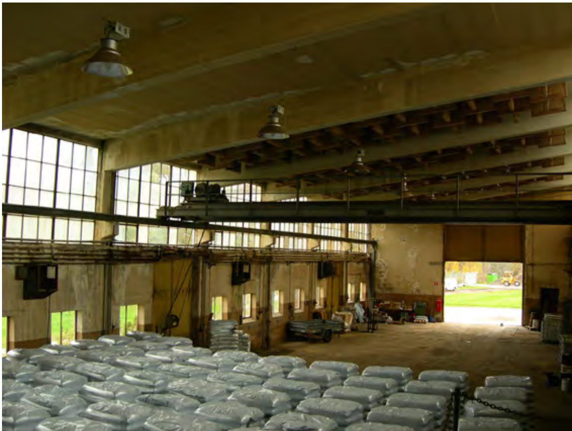
Interiör från verkstadslokalen som idag delvis används som förråd. Lägg märke till de märkliga plattorna i takets södra del. Det är så kallade ljudbafflar som används för att dämpa ljudet i lokalen. De är tillverkade av ett mjukt material, troligen sten- eller glasull. Lokalerna som inrymt el- och verkstadslager står idag oanvända.
