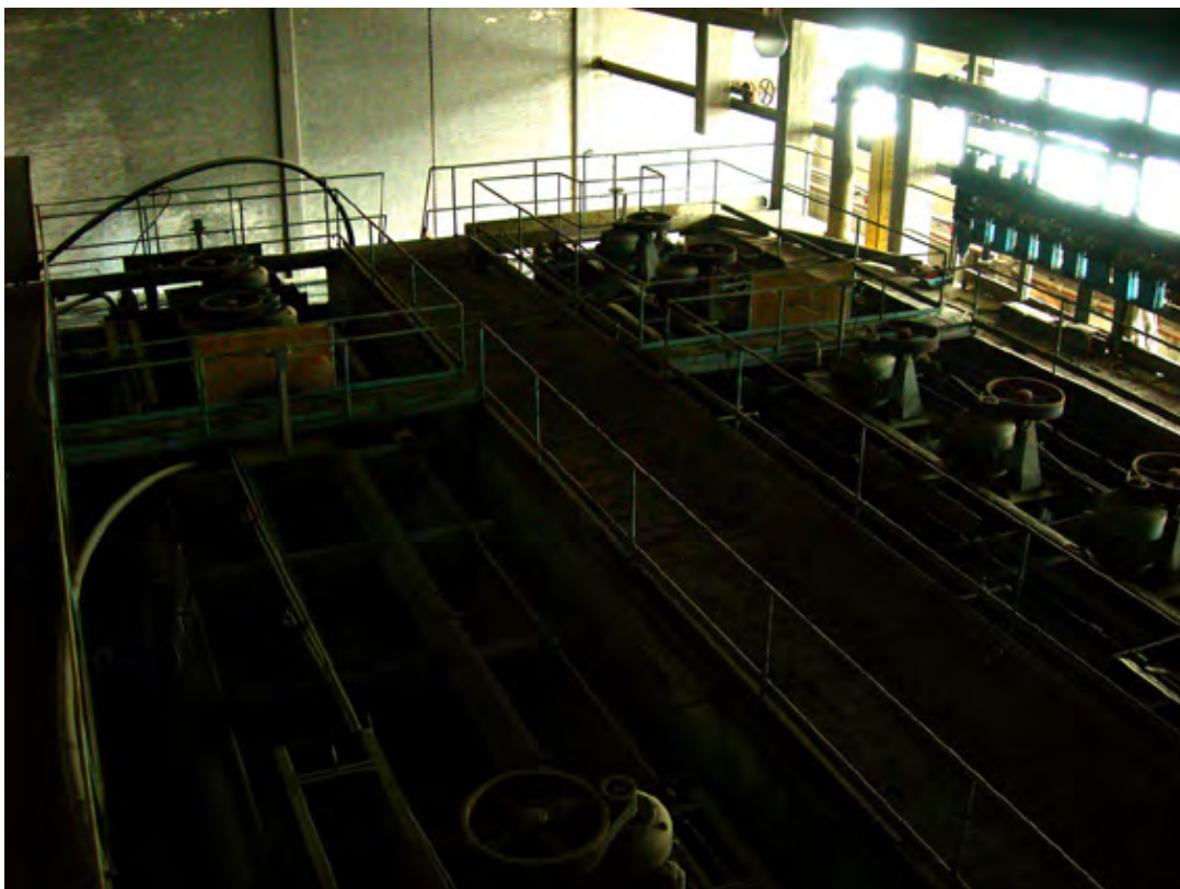
Flotationsanläggningens skumflotationsceller. Under dessa finns två vattenbassänger som distribuerade allt fabrikationsvatten.
