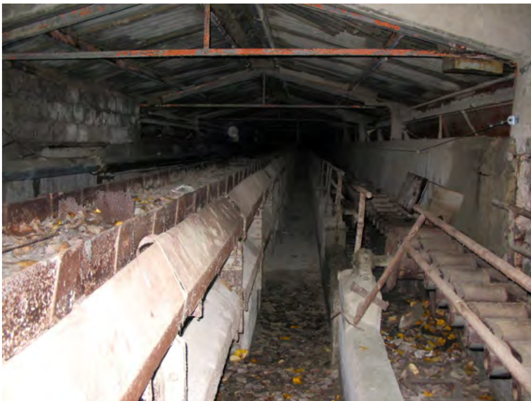
Mellan ugnshuset och lagerbyggnaden finns en transporttunnel, till hälften under jord och till hälften ovan jord. Till vänster syns en skakränna av stål där den varma klinkern transporterades från ugnshuset till lagerbyggnaden. Släpkedjan till höger är den ursprungliga transportanordningen som senare användes i reserv. Foto: HL
