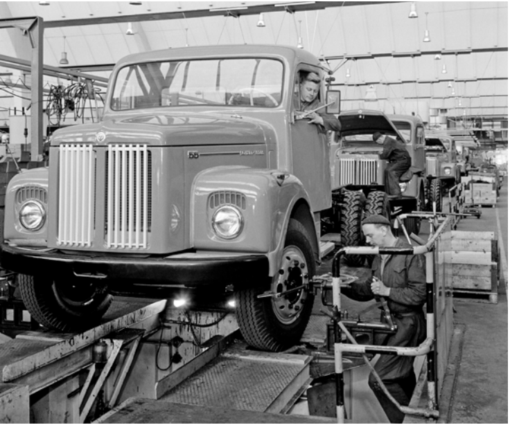
Den populära 51-serien ersattes 1959 av 55-modellen. Utåt sett var mycket gemensamt med den större 75:an, men med kortare motorhuv för den mindre D7-motorn. (Foto: Sören Flodqvist/Scania)
