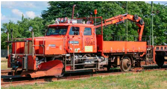
Motortrallan MTR101 baserad på 111:an byggdes i 50 exemplar i början av 1980-talet. Hiab 125-kran, flak och inbyggd vändanordning ingick i utrustningen. (Foto: Frederik Tellerup)
