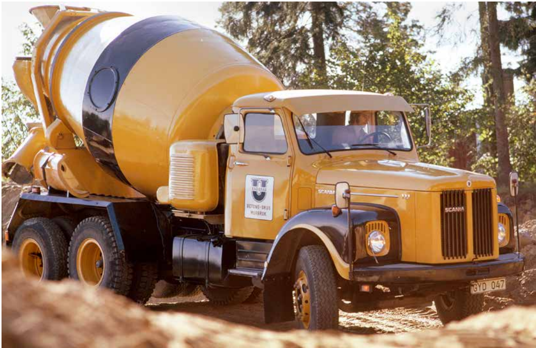
Som betongbilar var modellerna omtyckta. Underås i Södertälje hade Stetters femkubiks betongroterare på sina Scania LS111. (Foto: Scania)
