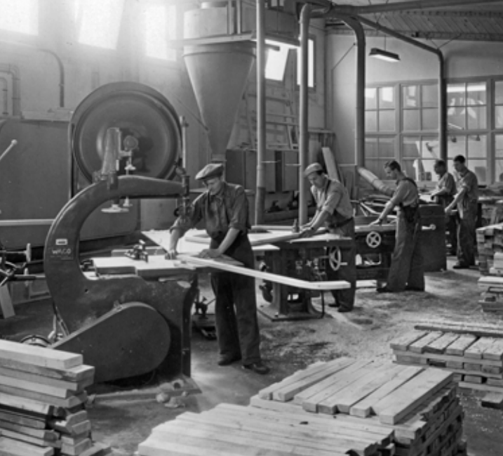
I snickeriverkstaden sågades alla hyttbitar av ramverket i trä omsorgsfullt till i bandsåg, hyvlades och frästes.
