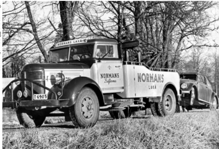
Volvo LV143 från 1946 gick med Tranåsaggregat som bärgare i Laxå från 1954 till 1965. Den hade den bredare HP-hytten med bubbla bakrutor.
