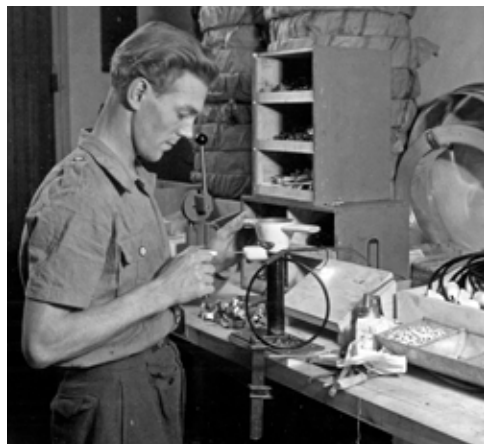
En av de anställda monterar ihop den elegant designade benvita körriktningvisarspaken. Den fanns också i svart.
