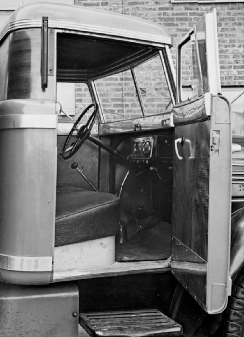
Lackerad träfaner, blankpolerad aluminium och helsoffa bjöds föraren i HP-hytten på. Att Helmer inspirerats av USA går inte att ta miste på.
