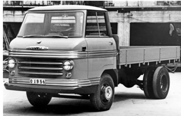
Prototyp till L3401 som den först hette, men snart L420 (och L430). Slutresultatet som lanserades 1956 fick dock inte lika exklusiva bårder i rostfritt, navkapslar och kromsarger runt lyktor och i grillen.
