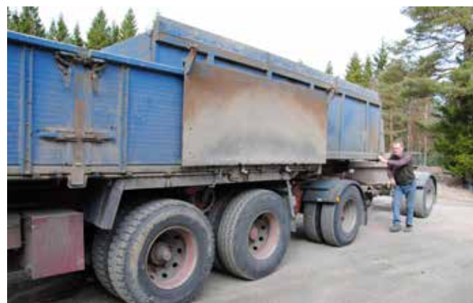
Kassettsystemet är konstruerat av Harry Jannesson och baljan drivs av två kraftiga startmotorer som får sin energi från två stora batterier.
