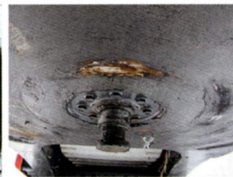
Skärningstendenser i glidytan hos en av de tre trailers som först krockade på Tranarpsbron i vintras.
