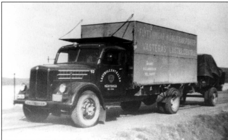
Scania-Vabis U4102, typ 2L13. Alltså med Scania's fyrcylindriga förkammarmotor på 90 Hk, och med det avlyftbara skåp som omtalas i artikeln. Gustav köpte den här bilen 1948. Den lastade 4450 kg, och år 1952 byttes den bort Hamnade-via ett antal åkare i Västerås -senare i Sörmland 1955. Ch nr 77759.
