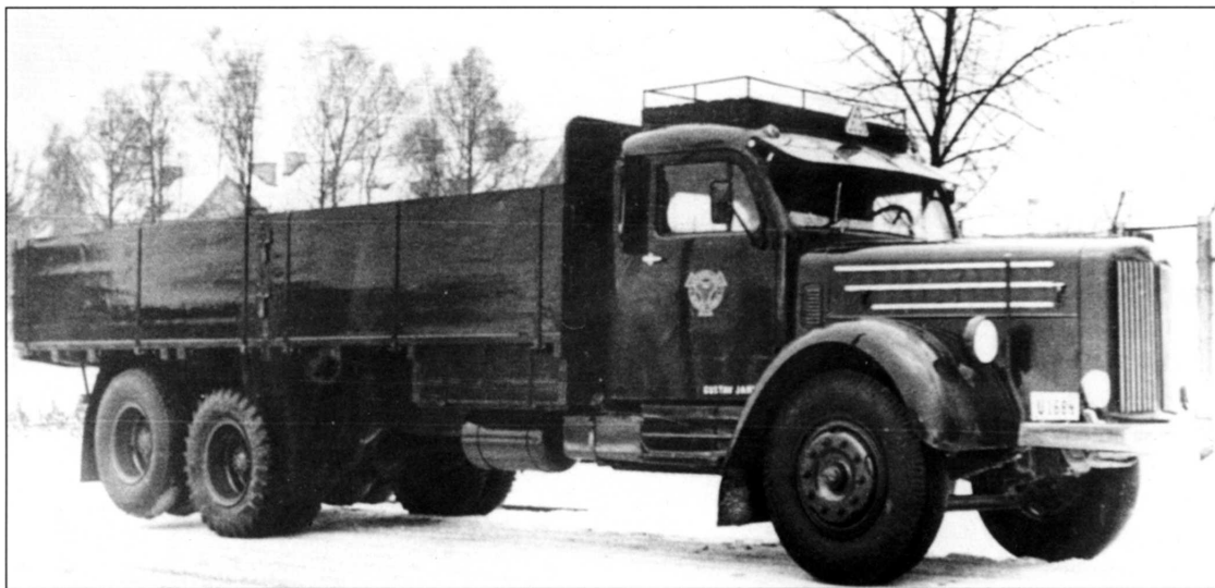
1952 års nyförvärv. Ett exemplar av den nästan legendariska typ LS 65. I detta fall Ch nr 85560. Den lastade 8370 kg. 1957 byttes den in hos Alvenius Bil, och blev A5319. Hitintills hade man använt enaxlig kärra. Nästa bil skulle få tvåaxlig vagn. Leveransfoto från Alvenius Bil.
