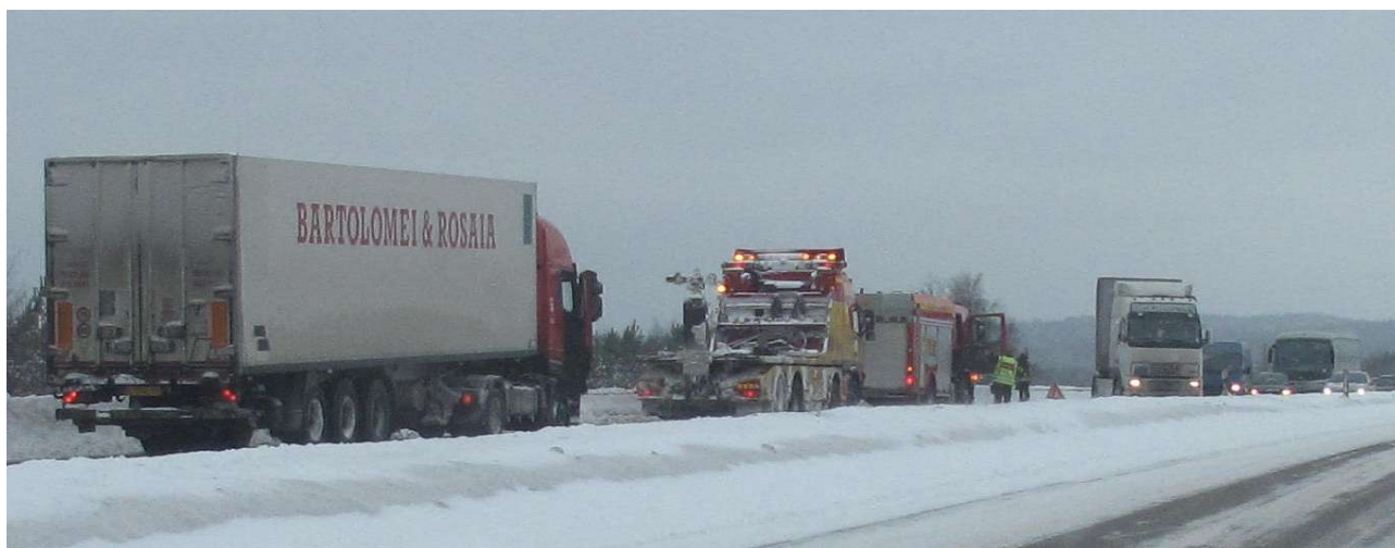
E4 Mjölby 2010-02019, Genom snö i körfält 2 särskilt för vänster hjul, har dragbilen fått ett "kast" som inte kunnat hävas av chauffören utan påbörjad vinkling gentemot trailern har bestämt färdriktningen så att ekipaget har "klippt" mitt-avskiljaren (vajerräcke) och hamnat på motorvägens mötande körfält. Av bilden framgår att körfält 2 är täckt av snömassor. Foto Per T.
