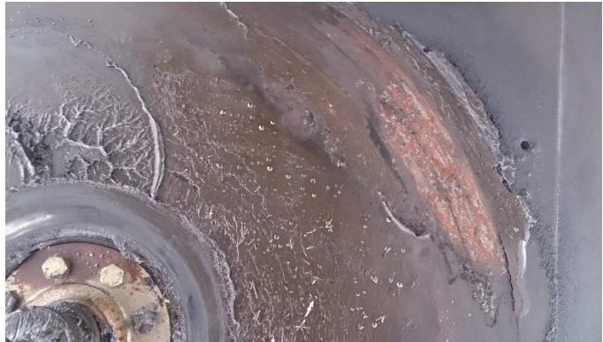
Tydliga skärningsstyr på hasplåten till trailern inblandad i olyckan vid Mogetorp. Foto: Bengt Eklund/Eget
