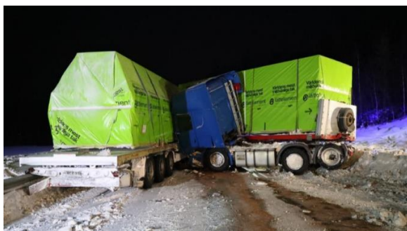
Ett svensktregistrerat 25,25 m linkekipage har vikt ihop sig vid Tavedal i Norge 2019. Uppförsbacke, boggin lyft ger dålig styrförmåga.
