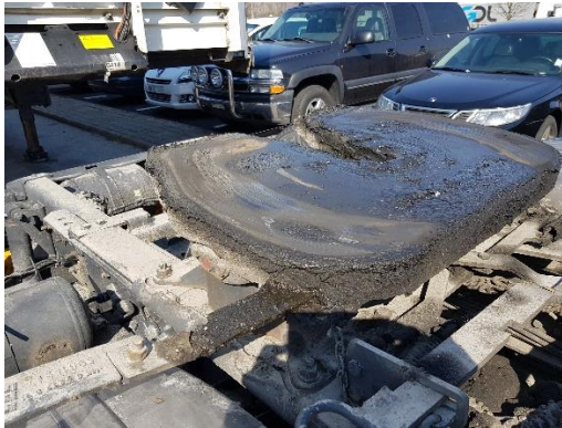
Så här ser det vanligtvis ut efter några dygns körning, allt fett borta vid ytterkanterna samt skärningsstyr. Foto: Eget
