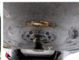
Skärningstendenser i glidytan hos en av de tre trailers som först krockade på Tranarpsbron i vintras.
