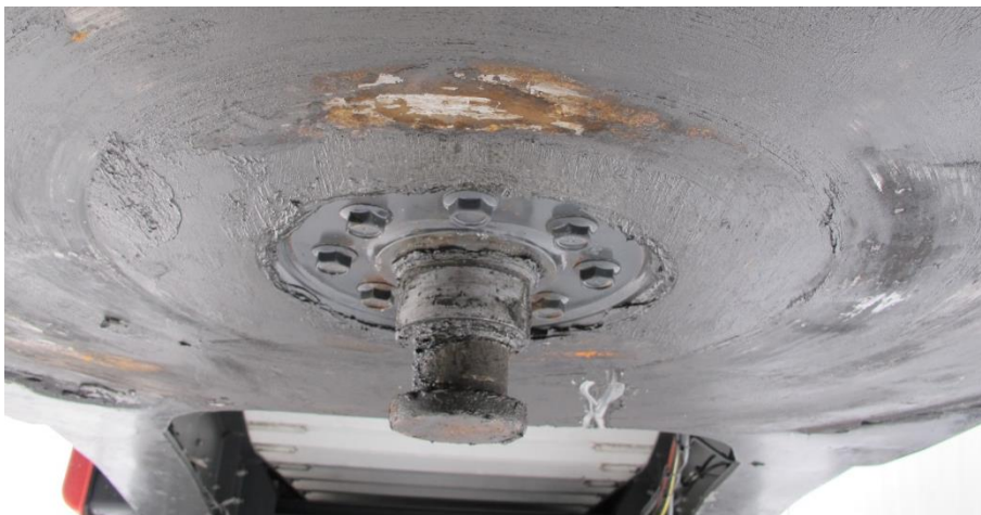
Ett av de tre trailerekipage som inledde masskrocken. Friktionen i trailerekipagets girled kan ha varit mycket hög, då slitplåten runt kingpin hade skavmärken i bar metall istället för ett jämnt tjockt lager vinterfett. Foto: P. Thomson.
