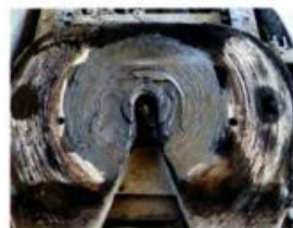
Skärningstendenser i glidytan hos en av de tre trailers som först krockade på Tranarpsbron i vintras.
